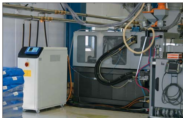
Molytex kan køre forskellige temperaturer på de enkelte maskiner, da den separate nye Frigel køleenhed har et reguleringsområde fra 5-90°C.
